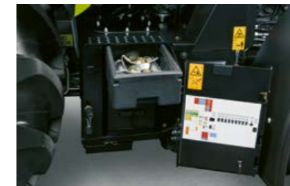
NIEUW: Rechts in de opstap vindt u gemakkelijk bereikbaar de accu, het gereedschapscompartiment en een persluchtaansluiting.
