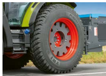
Het linker achterwiel kan tot 270 kg worden geballasteerd om het gewicht van de maaier te compenseren. Zo bent u altijd stabiel en veilig onderweg.
