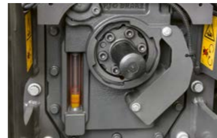
U kunt het oliepeil van de transmissie en het hydraulische systeem controleren via een kijkglas naast de aftakas.
