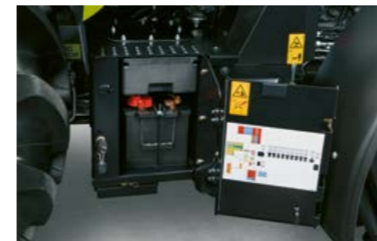
NIEUW: Rechts in de opstap vindt u gemakkelijk bereikbaar de accu, het gereedschapscompartiment en een persluchtaansluiting.
