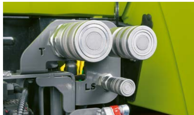
Voor werktuigen met eigen regelventielen zijn er voor het Load-Sensing-systeem achter aan de tractor Power-Beyond aansluitingen. Daarmee regelt het werktuig zijn oliebehoefte zelf, zonder permanente circulatie van de olie.
