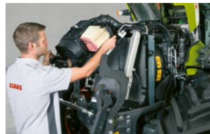
Het luchtfilter van de motor is voor de radiateurs ingebouwd en is gemakkelijk schoon te maken.
